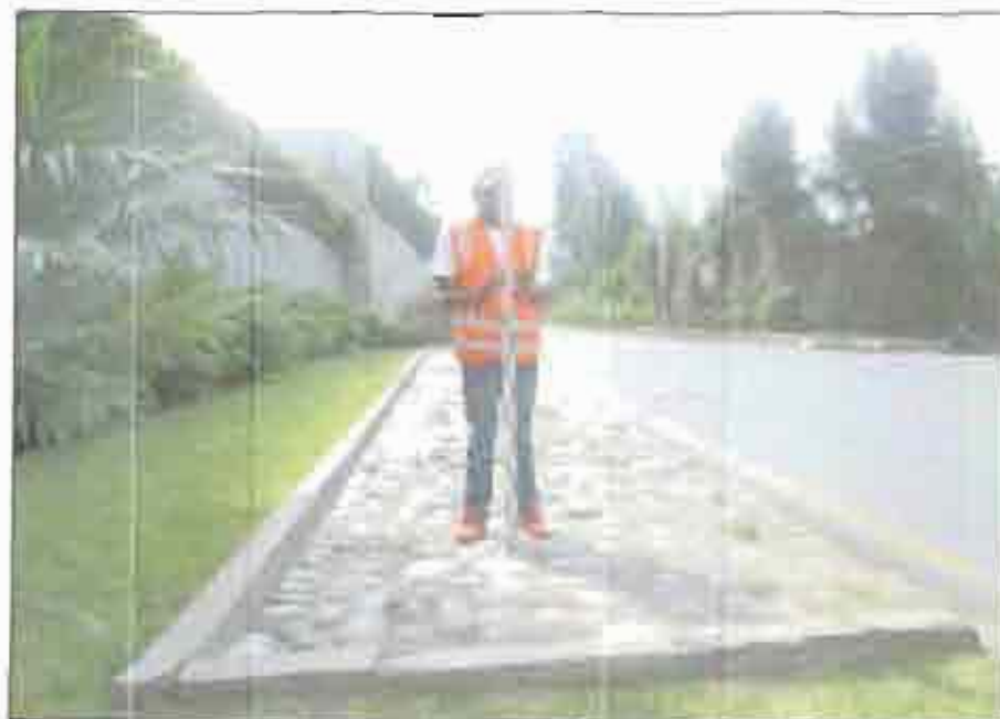
Foto 7 (Izquierda), Vista panorámica de la nivelación correspondiente al punto de cambio C-6, ubicada en la Av. Bello Horizonte, próximo a la Av. la Cañada. Foto 8 (Derecha), vista panorámica del punto de cambio C-7, esquina de losa de caja de agua, en la Av. Bello Horizonte en la intersección con Av. Bel Air I.
