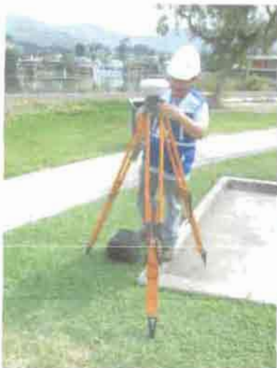
Vista panorámica del Receptor GPS Trimble R4-3, tomando lecturas, ubicado en punto Rober PG1
