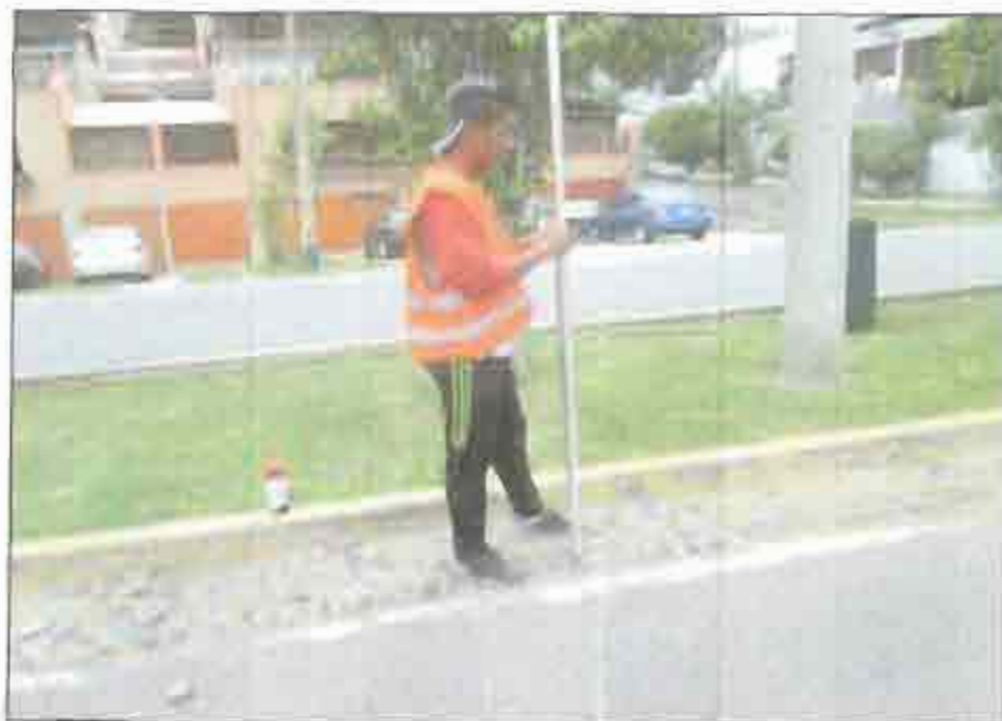
Foto 29 (Izquierda) Vista panorámica de la nivelación topográfica C-29, ubicado en la Av. Laguna Grande próximo al Punto Geodésico PG1 y Foto 30 (Derecha), Vista panorámica del Posicionamiento en el Punto geodésico PG1, ubicado en la Av. Laguna Grande, clavo de acero incrustada sobre el vardinel de concreto, al costado de la laguna.
